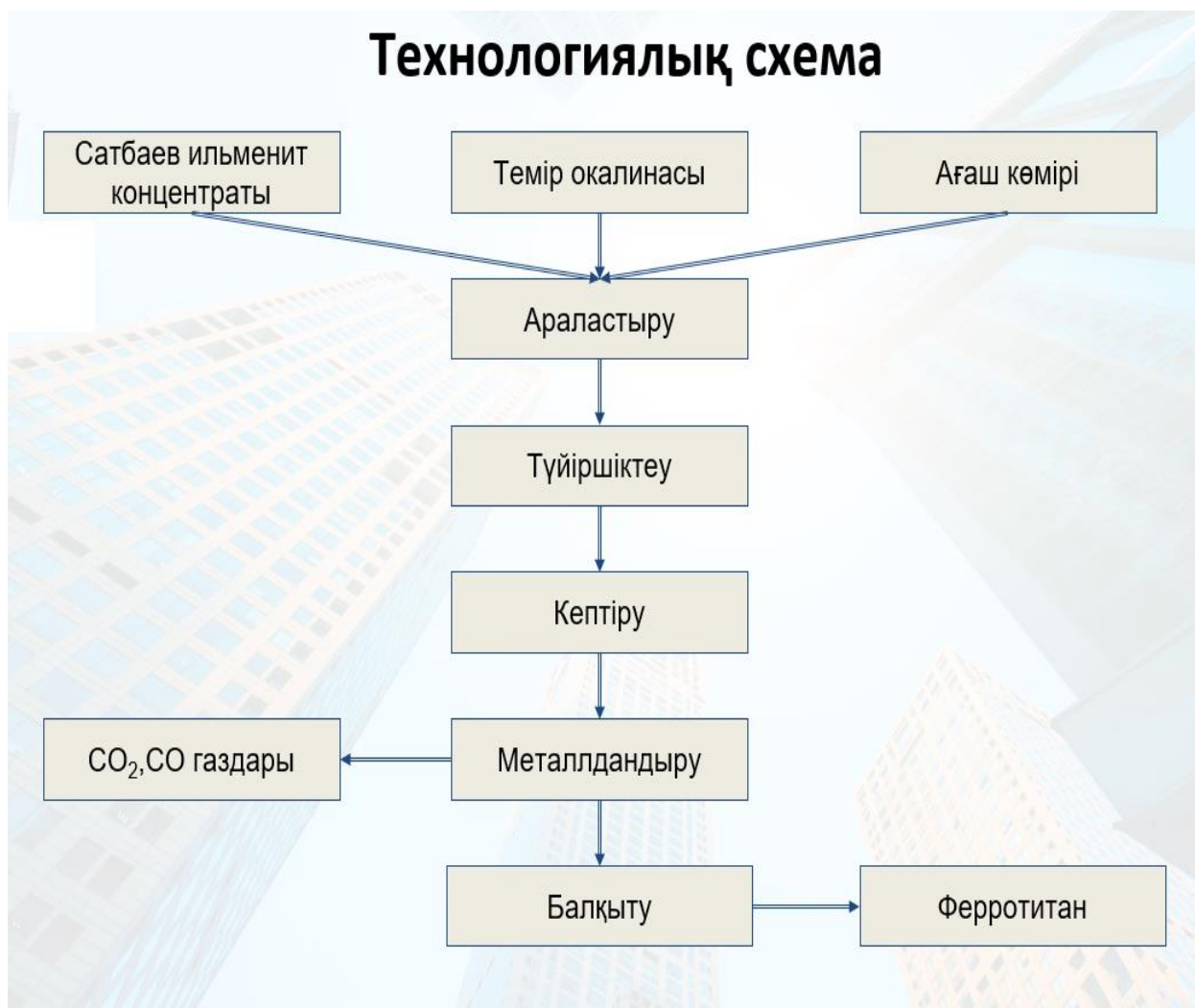
18-сурет – Жоғары пайызды ферротитанды алудың технологиялық схемасы
